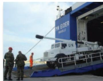
Le CAESAR est un engin moderne, qui équipe déjà les forces françaises en Afghanistan. Ses atouts résident dans sa relative **légèreté** (18 tonnes) et dans sa **mobilité** (il est monté sur un camion 6x6). Armé d'un canon de 155mm, le CAESAR est également capable d'une **grande efficacité opérationnelle** : en moins de trois minutes, il peut quitter sa position de route et tirer jusqu'à six obus en moins d'une minute à une distance pouvant atteindre 40 kilomètres.
